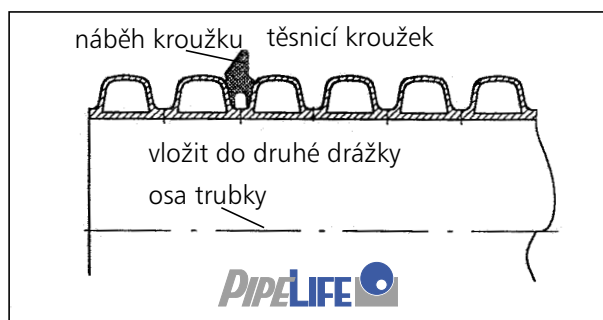
Schéma vložení kroužku do vlny
